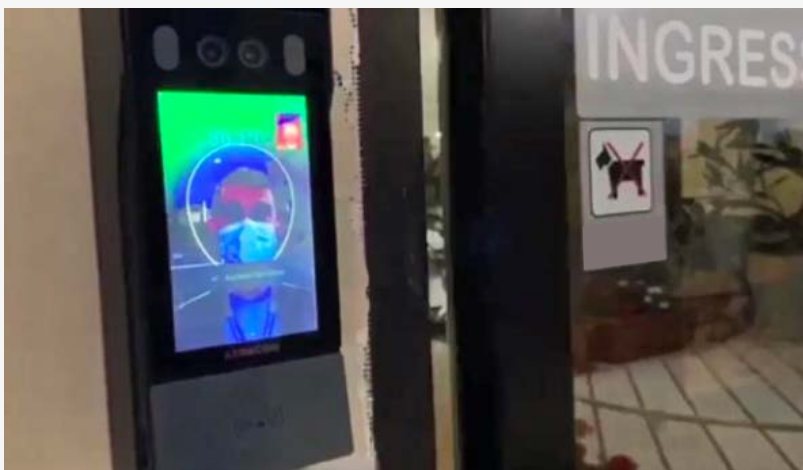
Termocamera KRFT collegata a una porta scorrevole come controllo preventivo degli accessi.
